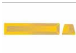
Prismas - substituem a guia da calçada (meio-fio) quando não for possível sua construção imediata
